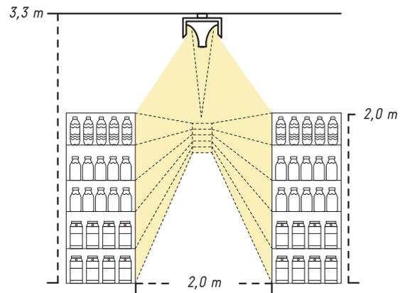
Der Doppelrichtfluter mit NX-Reflektor wird bei einer Lichtpunkthöhe von 3,30 m eingesetzt und eignet sich mit seinen doppelseitigen Reflektoren ideal für die Gangzonenbeleuchtung.
