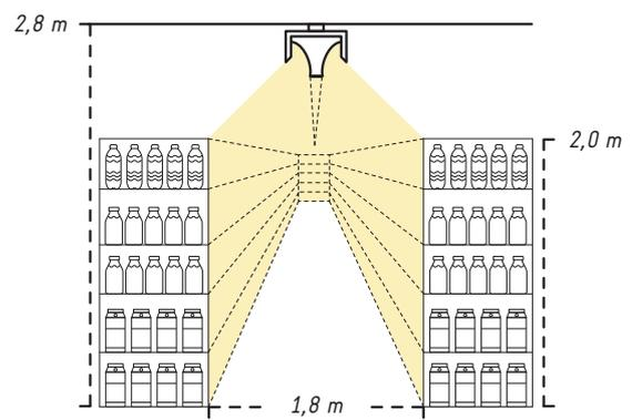
Bei einer geringeren Decken- und Lichtpunkthöhe wird der Doppelrichtfluter mit NB-Reflektor eingesetzt, um auch in einem stumpferen Winkel eine brillante Warenausleuchtung auf beiden Seiten zu gewährleisten.
