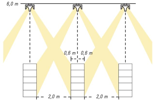
Mit einer bevorzugten Stromschienehöhe von 6,0 m bietet der lichtstarke Doppelrichtfluter eine effiziente Warenbeleuchtung verschiedener Gangzonen.
