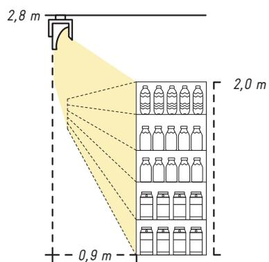
Bei einer Lichtpunkthöhe von 2,80 m wird der einseitige Richtfluter mit NB-Reflektor eingesetzt. Er sorgt, mit einem geringen Abstand zum Regal, für eine effiziente und zielgerichtete Warenpräsentation.
