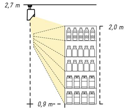
Bei einer Lichtpunkthöhe von 2,70 m wird der einseitige Richtfluter mit NB-Reflektor eingesetzt. Er sorgt, mit einem geringen Abstand zum Regal, für eine effiziente und zielgerichtete Warenpräsentation.
