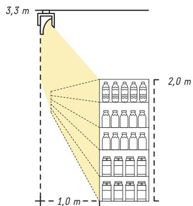
Der Richtfluter mit NX-Reflektor wird bei einer Lichtpunkthöhe von 3,30 m eingesetzt und bietet damit eine perfekte und farbrillante Ausleuchtung Ihrer Waren.
